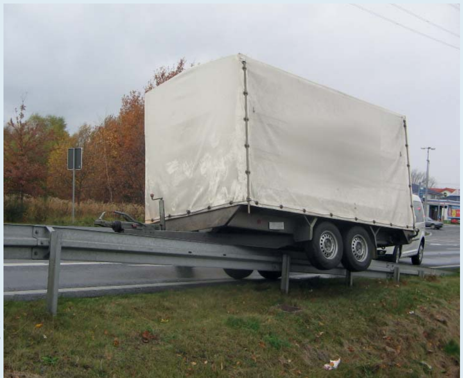
Dieser mit Ortungstechnik ausgerüstete Anhänger wurde weder richtig angehängt noch war die Abreißbremse eingehängt. Technische Defekte scheiden aus. Der Fahrzeugführer hat schlicht nachlässig gearbeitet. Verletzt wurde zum Glück niemand.
