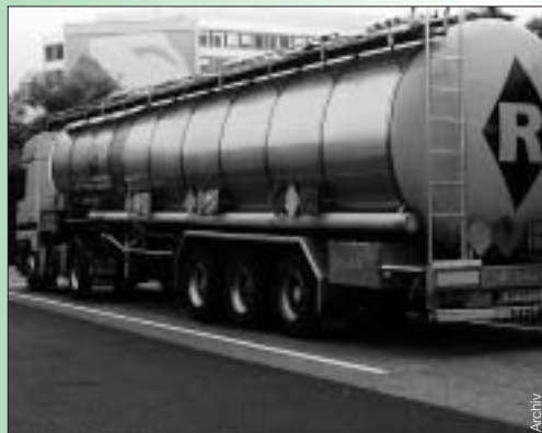
Unser Foto aus dem Oktober-Heft, S. 5, zeigte ein Tankfahrzeug mit Tankdomen. Diese haben – im Unterschied zu Tankcontainern – fast immer ein aufklappbares, fahrzeugintegriertes Geländer.
